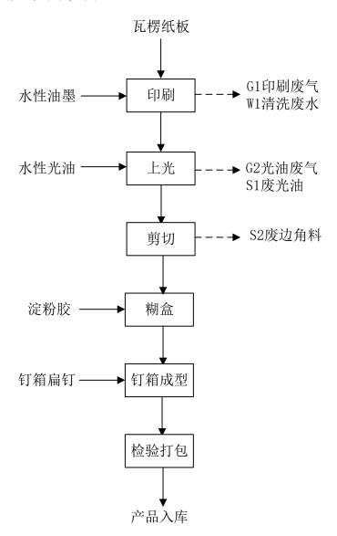
图 2-2 生产工艺流程及产污环节图
